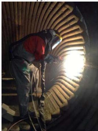
Рис. 11. Процесс нанесения покрытия
