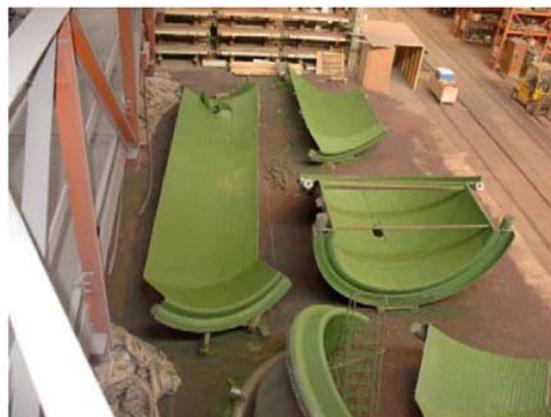
Рис. 14. Элементы с керамическим покрытием
