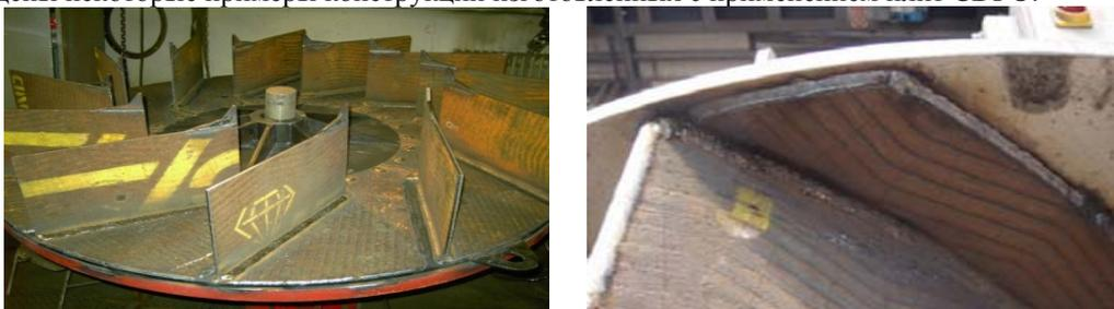
Рис. 4. Пример конструкций из плит CDP. Слева – вентилятор изготовленный целиком из плит, справа – лопасть изготовлена из плиты, на диск приварена износостойкая накладка из CDP.
