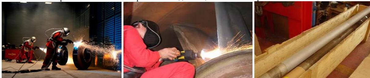
Рис. 9. Слева на право: напыление радиального вентилятора, напыление осевого вентилятора, чехол термопары с покрытием Eutronic Arc 595.
