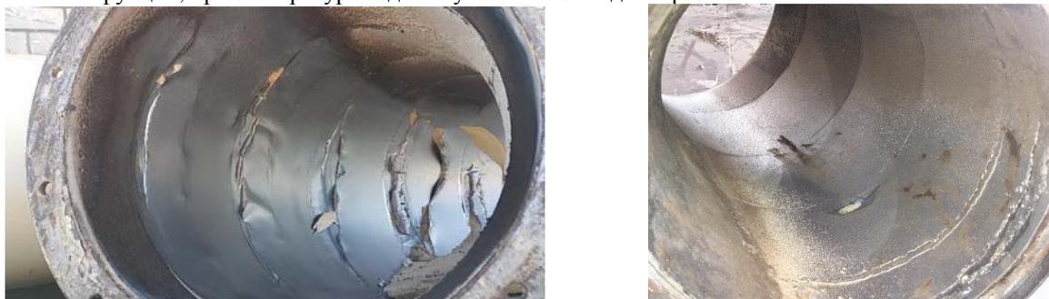
Рис. 8. Отвод системы аспирации предприятия по деревообработке. Слева – без покрытия после 3-х месяцев эксплуатации, справа – с нанесенным покрытием после 12 месяцев эксплуатации.
