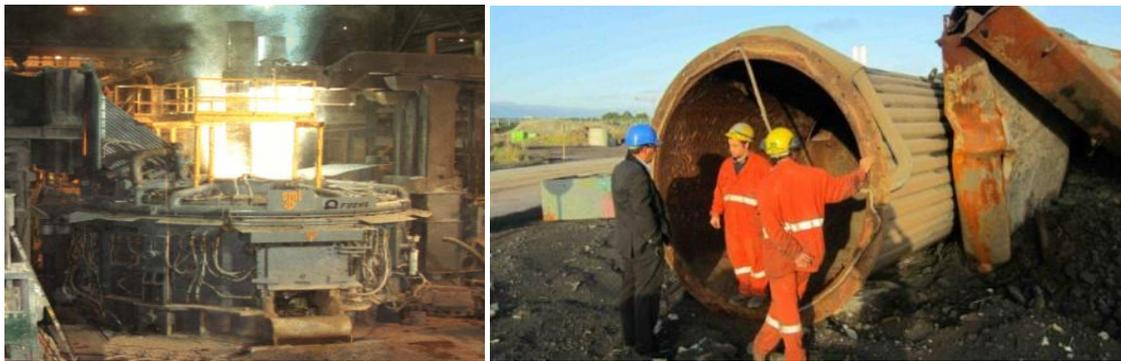
Рис. 10. Слева - общий вид электродуговой печи. Справа – изношенные элементы газохода
