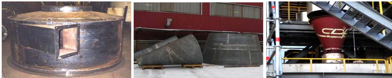
Рис. 6. Элементы циклонов наиболее подверженные износу, изготовленные из износостойких плит.
