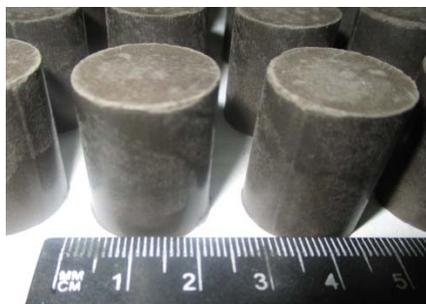
Рис. 2. Брикеты из циклонной и рукавной пыли
