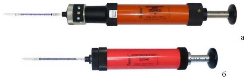
Рис. 3 Индикаторные трубки в комплекте с аспиратором типа НП-3м (а) и типа НП-4 (б)
