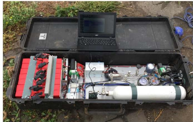
Фото 4. Испытания Автоматизированной системы автономного контроля промышленных стоков (АСАКС) в АО «Мосводоканал»
