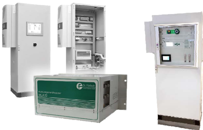
Рис. 7. АИС «горячего-влажного» анализа (слева) и «холодного-сухого анализа (справа)
