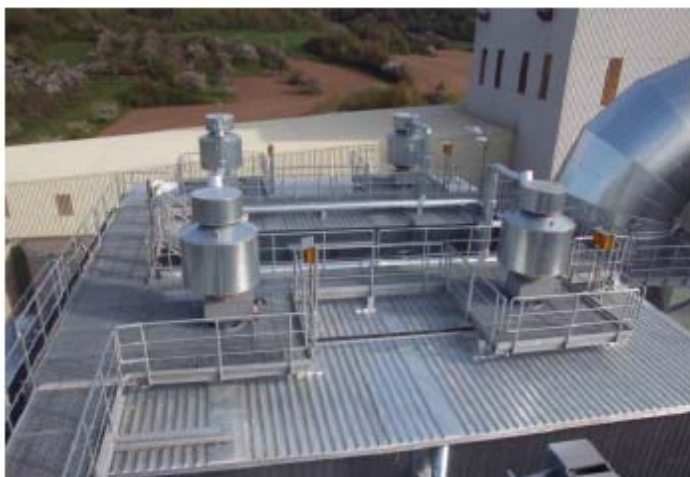
Рис.5. Резервуар сжатого воздуха со встроенными мембранными клапанами
