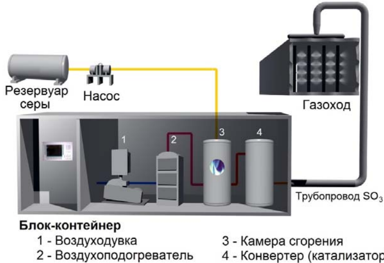
Рис.2. Схема размещения оборудования для кондиционирования дымовых газов
