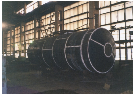
Цистерна под соляную кислоту защищенная ламинатом «Ремохлор»
