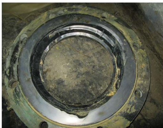
Фото 1, 2. ТЭС Гацко, Босния. Уплотнение и купольный клапан «Копар», 6.0 месяцев эксплуатации.
