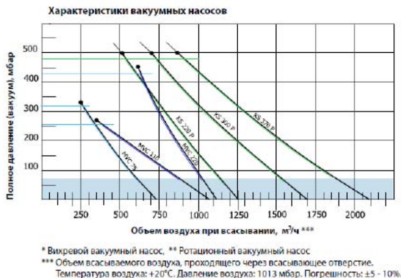
Рис. 5. Номограмма характеристик вакуумных насосов Wieland (мощность от 11 до 37 кВт).
