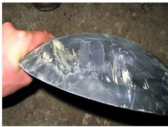
Фото 1, 2. ТЭС Гацко, Босния. Уплотнение и купольный клапан «Копар», 6.0 месяцев эксплуатации.
