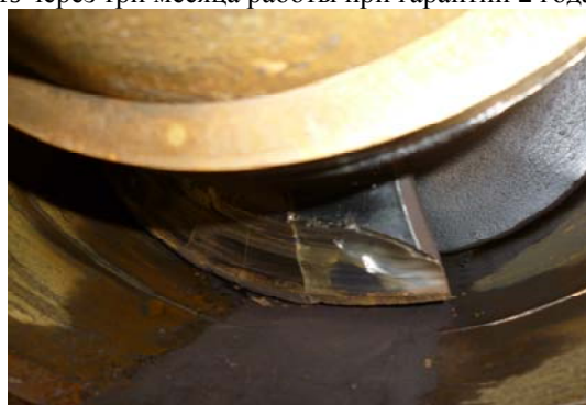
Фото 8. Разрушение шнека с износостойким покрытием
