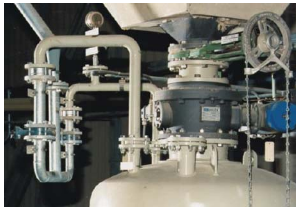
Рис. 4. Место установки клапана со сферическим затвором
