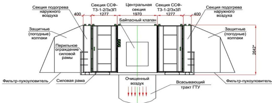
Принципиальная схема одного из вариантов ВОУ (КВОУ) для ГПА-Ц-6,3.
