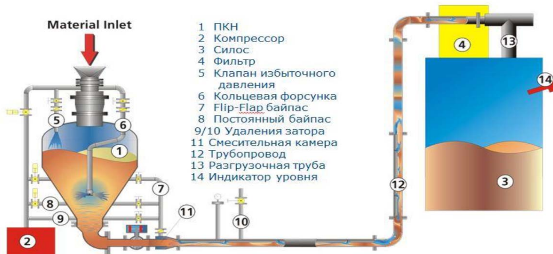
Рис.2. Основные элементы системы транспортировки с ПKN.
